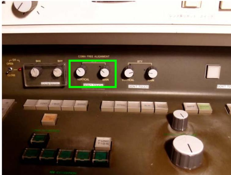
Wobblerの運動を左メインパネルのCOMA FREE ALIGNMENT調整つまみ、[BTX]と[BTY]で下図のようになるよう調整する。
