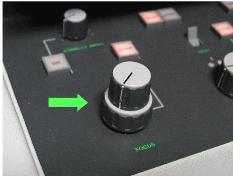
右メインパネルのFOCUSつまみを回して試料の焦点を合わせる。
