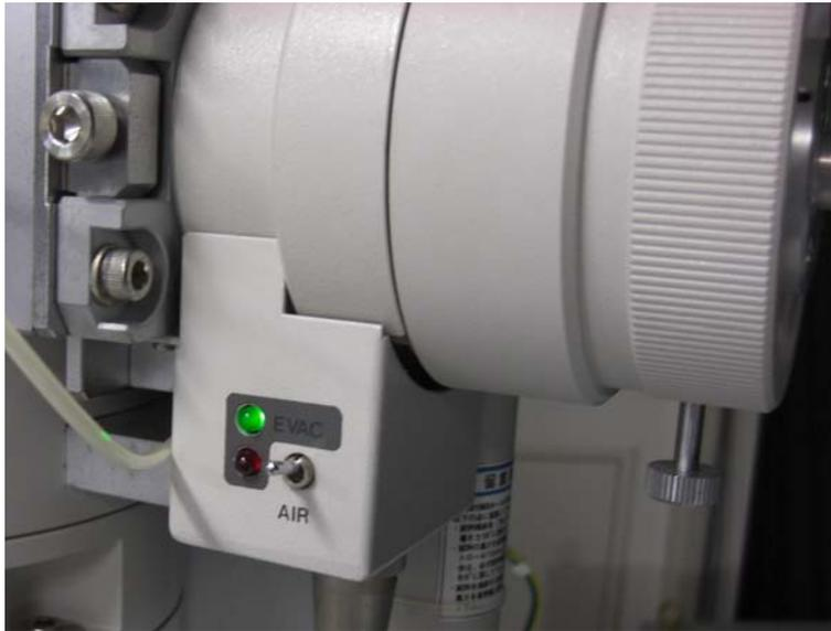
約2分程度待機していると、【EVAC】の緑ランプが点灯しブザーが鳴るので、ブザーが鳴っている約15秒間に試料ホルダーを挿入する
