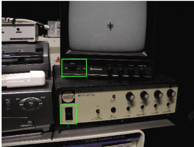
CCDカメラのコントロールとモニターの電源がOFFであることを確認
