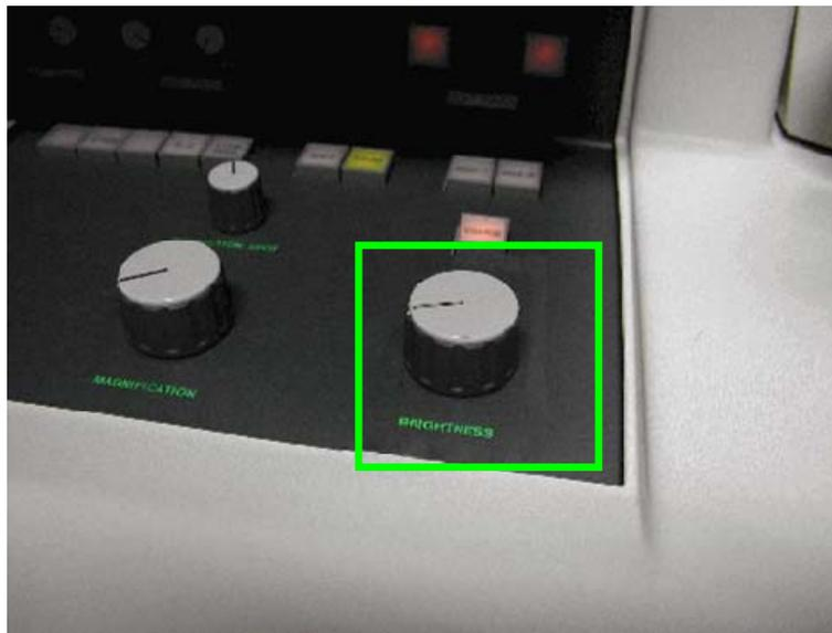
左メインパネルのBRIGHTNESSを調節し、回折斑点が点になるようにビームを広げる。
