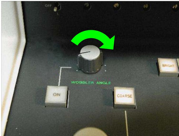
BRIGHTNESSでビームを絞り、[Wobbler Angle]のつまみを時計一杯に回してWobblerをX軸方向に振動させる。
