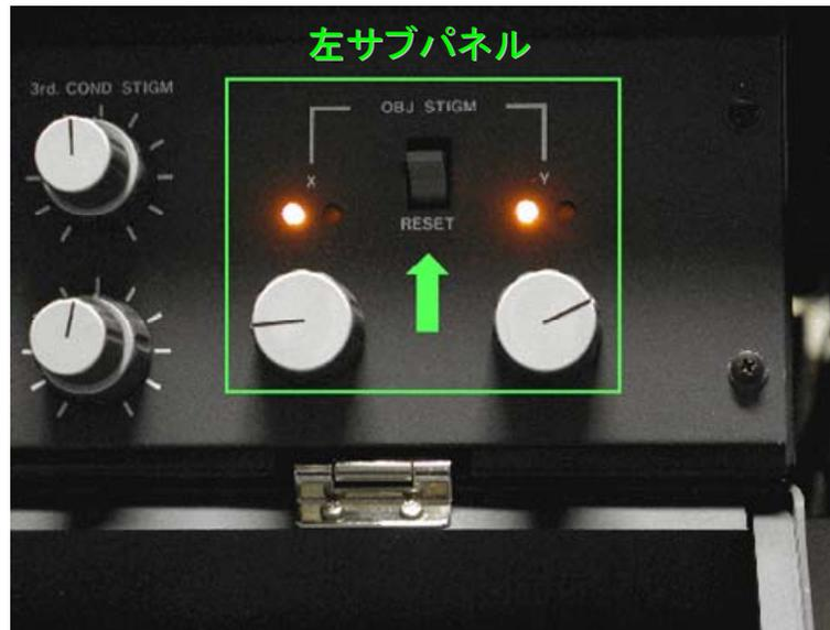
左サブパネルのOBJ STIGM-XYを使って非点収差を補正する。
