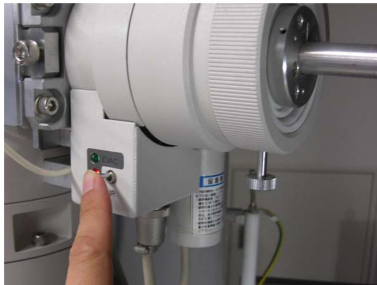
試料交換スイッチを【AIR】→【EVAC】に切替える
