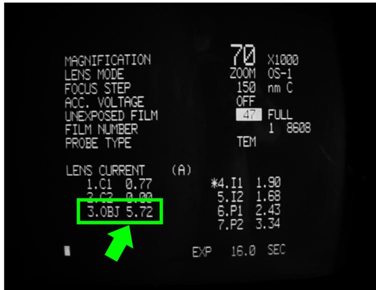
CRTに表示されているLENS CURRENTのOBJの値が5.72から大きくずれていない事を確認する。
