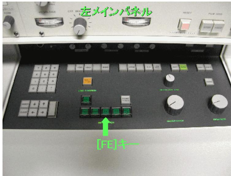
左メインパネルの[FE]を押し、[FLASH]キーが点滅している間に[FLASH]を押す
