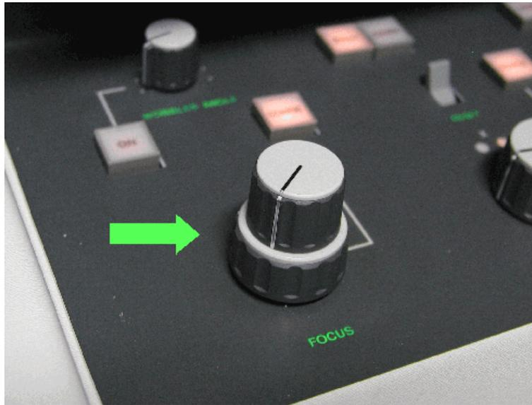
右メインパネルのFOCUSつまみを回して試料の焦点を合わせる。
