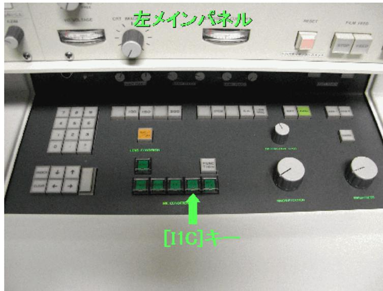
V0およびV1昇圧中は[FE]が点滅、その後、[I1C]が点滅し、エミッション電流が設定値になるまでV1が昇圧。
