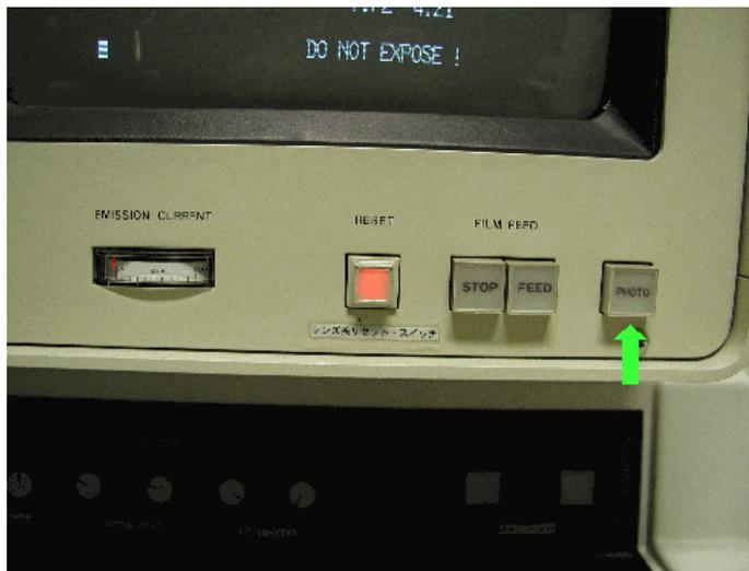
写真撮影する像あるいは回折パターンを蛍光板上に映し、CRT左側のEXPOSRE TIMEを選択する。
