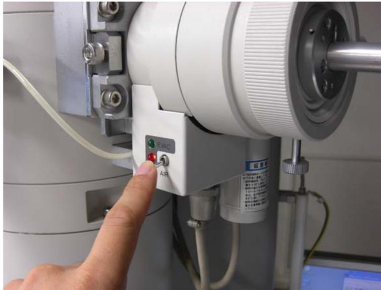
鏡筒にセットされている試料ホルダーを取り出すため、試料交換排気スイッチを“AIR”にする
