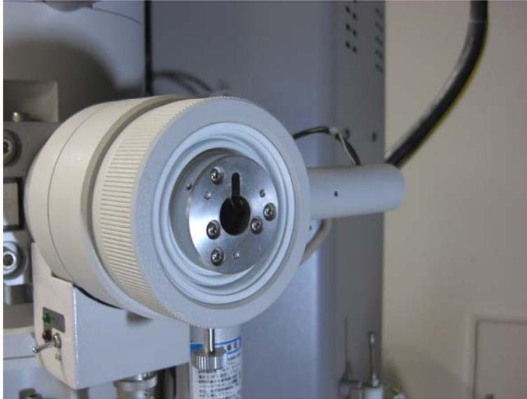
試料ホルダーのガイドピンをシリンダ溝に合わせ、止まるまで挿入する(A位置)
