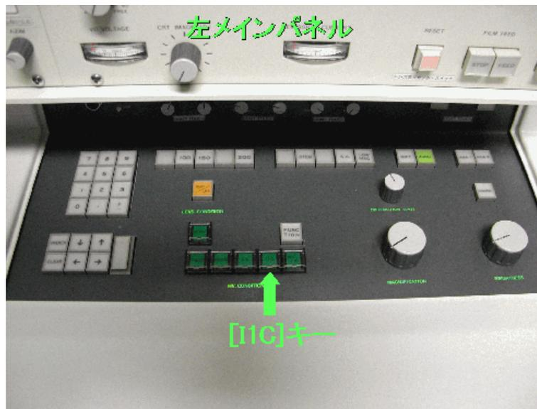
昇圧完了後、40分間待機。その後左メインパネルの[I1C]を押し、エミッション電流の自動設定が完了したらになったら使用開始。
