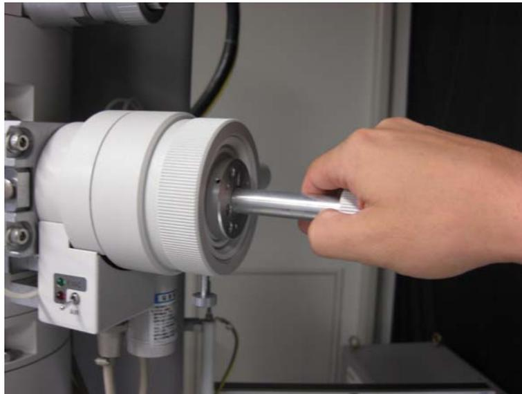
右メインパネルの VACUUM STATE の SPEC AIR の赤ランプが点灯した後、試料ホルダーをゆっくりと、まっすぐ引き出す
