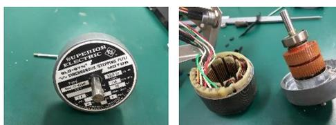
図3 ステッピングモータ外観(左)と内部の様子(右)
