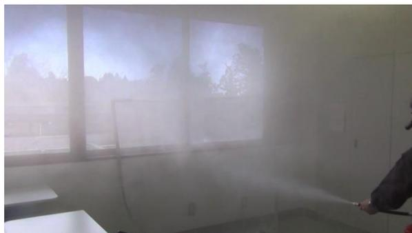
図2 中性帯に水消火器を噴射した様子
