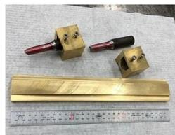
図 2 破断試験片固定用ブロック (上) と固定ブロック用ルール (下).
