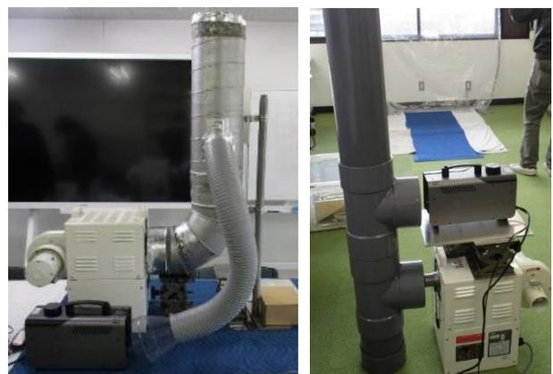
図1 中性帯煙発生機（左：金属管，右：塩ビ管）
