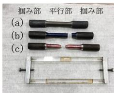
図 1 (a)試験片 (180mm×平行部 φ14mm, 掴み部 φ20mm). 破断試験片: (b)脆性材料 FC200, (c)延性材料 SS400. 下: フレーム型復元治具.
