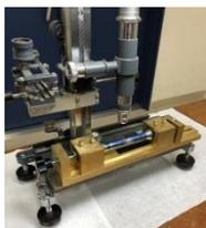
図 3 開発した治具による読取顕微鏡での変形量計測.
