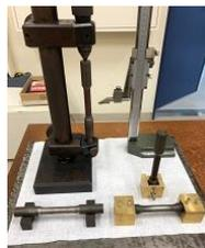
図 6 けがき台(左上)とVブロック(左下)を開発ブロックに置き換えた場合(右下2つ)。右上:ハイトゲージ。
