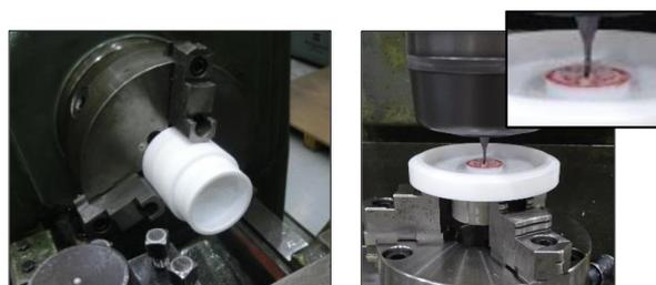
図3 加工写真 (左: 旋盤加工, 右: フライス盤加工)
