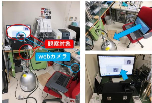
図5. web カメラでの動作監視時の配置
