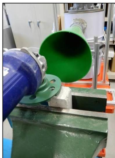
図-2 乾式加工時の集塵の様子
