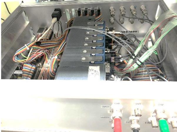
図4 CompactRIO の組み込み写真
