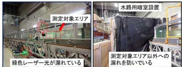
図3 レーザー光の漏れ比較
