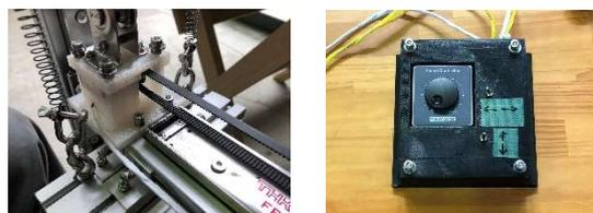
図4 水平駆動とコントローラー
