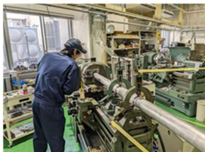
旋盤による長物加工
