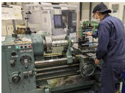
旋盤による鋼管の加工
