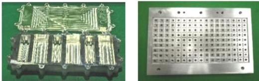
図1 フライス盤加工品の例
