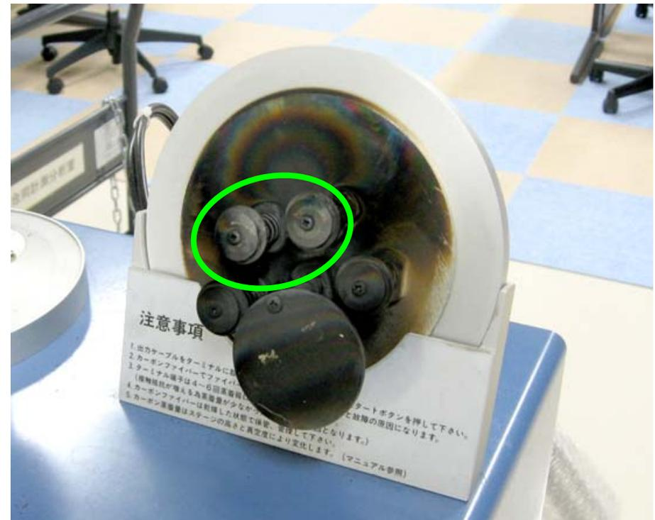
上部の端子にカーボンファイバーを取り付ける
